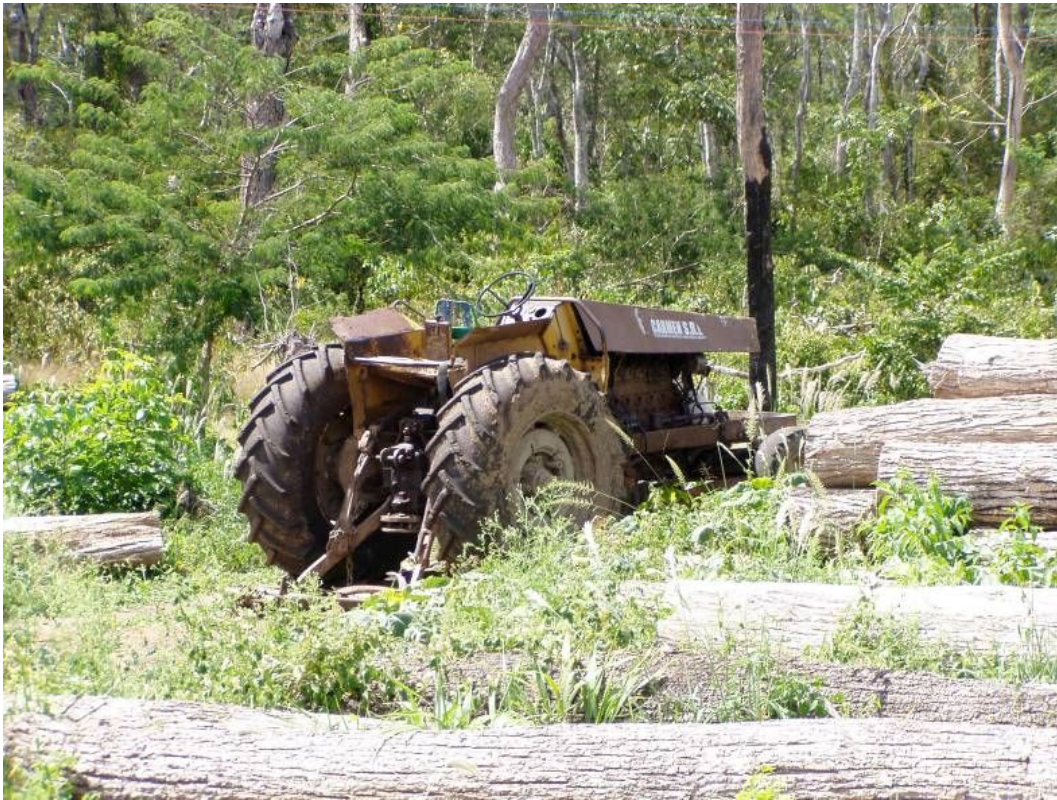
FOTO 5.7. Operación de “rodeo” de las trozas en un manejo comunal
